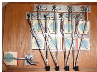
ESEMPIO MECCANICA BASSI DIATONICO “DIRETTA”
