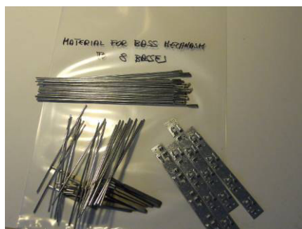
COD. COBM0003 - ASTE CILINDRICHE PER PISTONI BASSI COD. COPO0001- STRISCE METALLICHE "PORTARIPETINI" COD. CORI0001- "RIPETINI" MECCANICA BASSI DA PIEGARE
