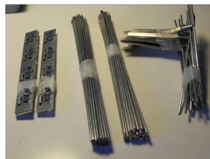
COD. COBM0003 - ASTE CILINDRICHE PER PISTONI BASSI COD. COPO0001- STRISCE METALLICHE "PORTARIPETINI" COD. CORI0001- "RIPETINI" MECCANICA BASSI DA PIEGARE
