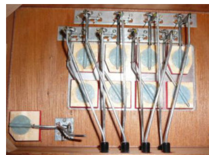
ESEMPIO MECCANICA BASSI DIATONICO “DIRETTA”
