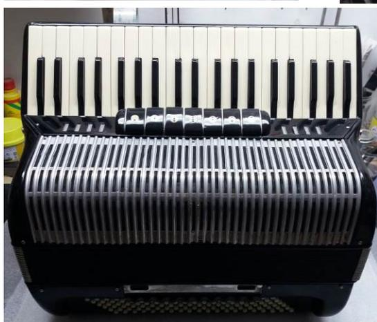
*Acordeón completamente reconstruido (caja del canto y caja de los bajos) , nuevo revestimiento de celuloide, revisión de teclado, nuevo mecanismo de los bajos, revisión de registros de canto y bajos, nuevo fuelle, trabajo completo en las voces y limpieza de la parrilla*
